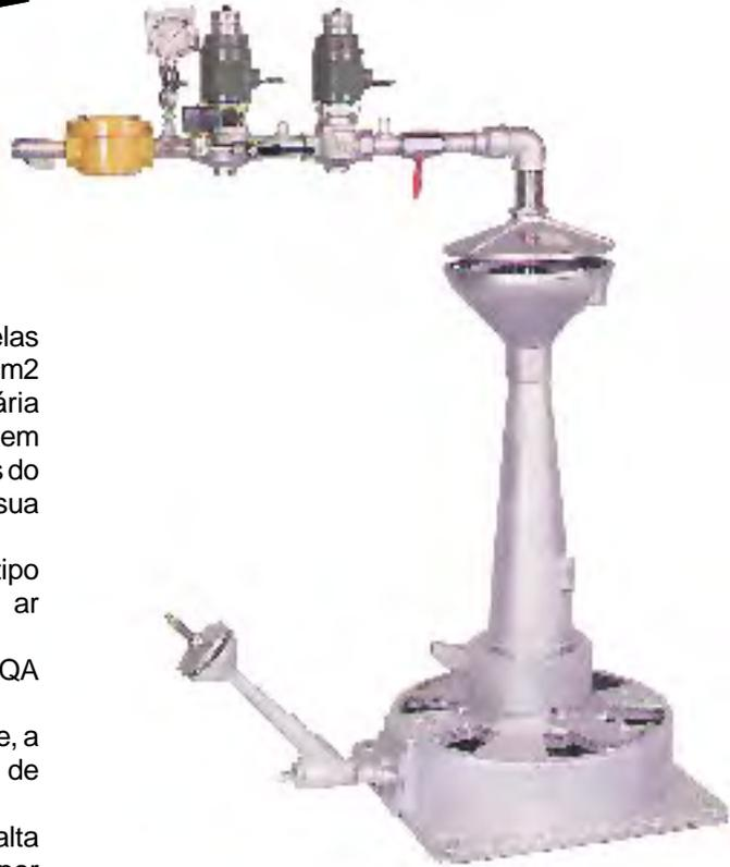
Os queimadores de gás EQA 93 utilizam-se naquelas instalações onde a pressão disponível é de 0,2 a 3 km/cm<sup>2</sup> sendo a energia produzida pelo próprio gás, a única necessária para seu funcionamento, ou seja não requer ventilador nem compressor. O fluxo de gás a alta pressão, ao passar através do venturi aspira o ar necessário para sua combustão, que por sua vez controla e regula por meio de registro de ar primário.
