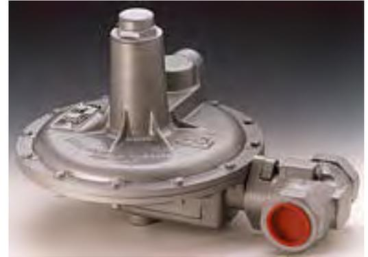
**Regulação:** As pressões de saída das válvulas redutoras EQA S-201 / 202 são reguladas mediante o ajuste dos diferentes tipos de molas com que se provêem em cada caso. São variáveis também os diâmetros de orifícios segundo seja as pressões de entrada e as vazões a utilizar : 1/4" (6,4 mm), 3/8" (9,5 mm), 1/2" (12,7 mm), 3/4" (19mm), 1" (25,4mm), 1 3/16" (30,2mm).
