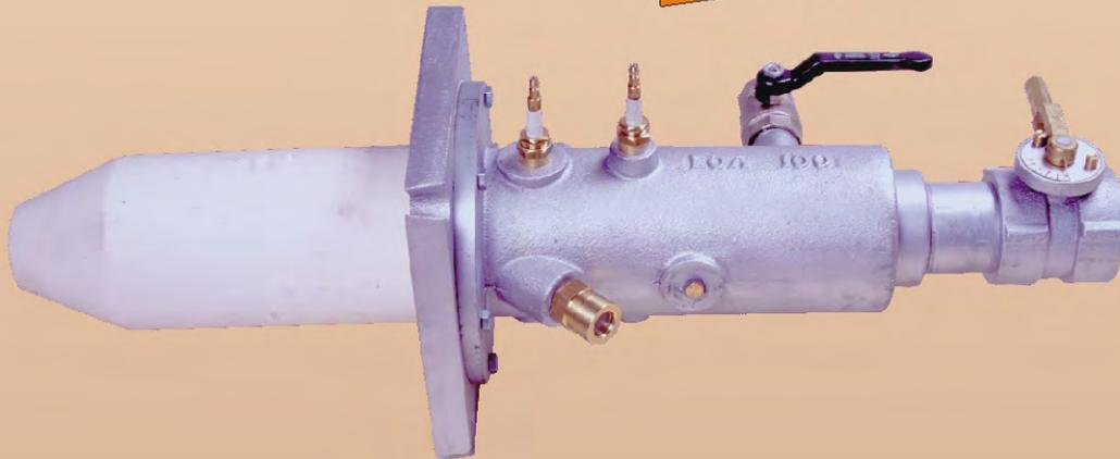
Los quemadores de alta velocidad EQA 100 son de mezcla en cono ó block adaptables a una variada gama de aplicaciones. Pueden trabajar con gas natural, butano, propano o gas pobre.
